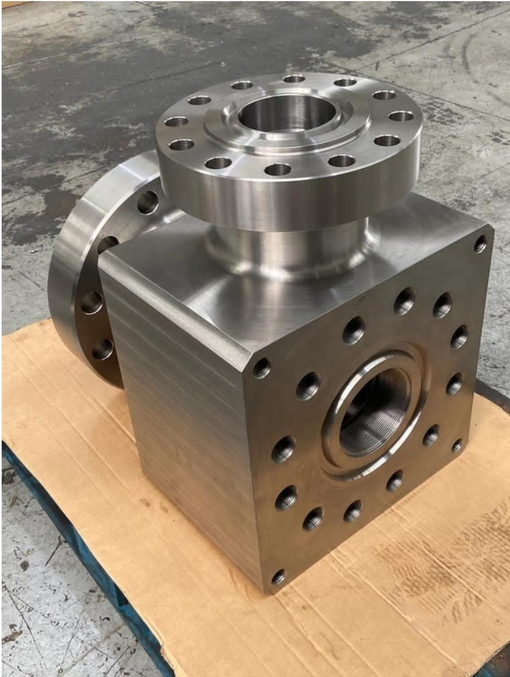
M&M Jomar est devenu un Spécialiste de l'usinage de vannes de différents types et applications pour les secteurs industriels tels que la pétrochimie les usines de papier, les machines agricoles, l'outillage industriel et nucléaire et des matériaux tels que l'inconel, le titane et l'acier au carbone.
